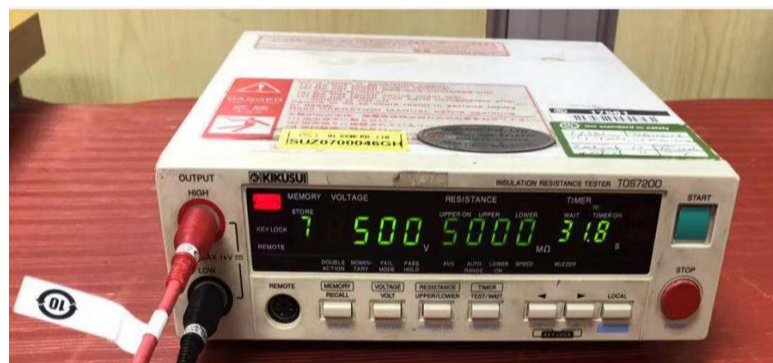
II.A.5.2 - Ensaio de resistência de isolamento da luminária
