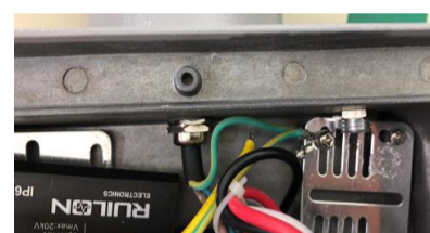
II.A.2.1.1 - Ensaio de tração do cabo de alimentação da luminária
